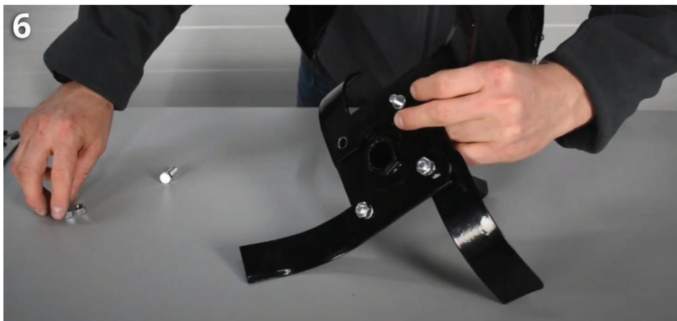
Rys.7. Sekcje noży łączymy między sobą za pomocą sworzni które blokujemy zawleczkami.
