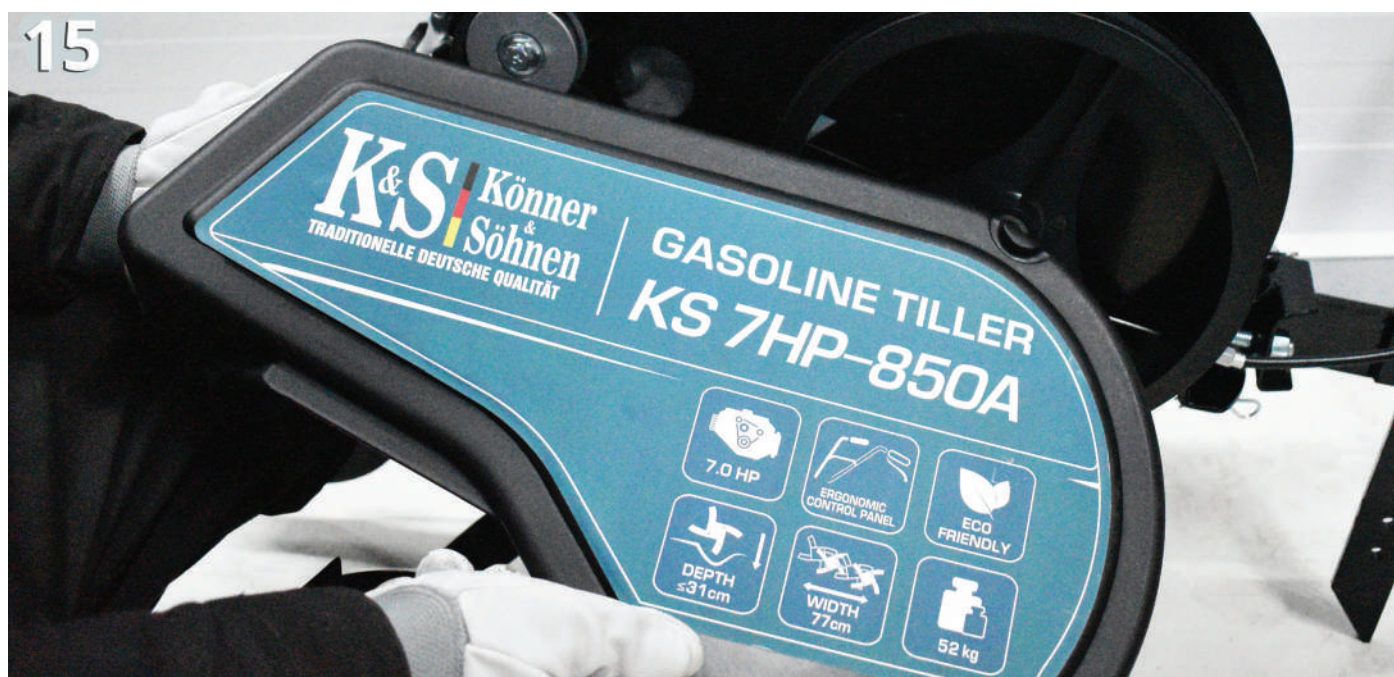
Rys.15. Montaż osłony ochronnej na obudowie glebogryzarki.
